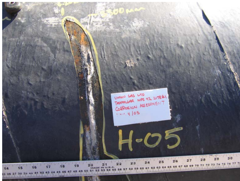
82) H-05 Corrosion and Sand 58
