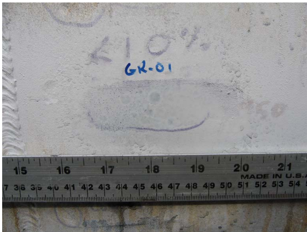
36) GR-01 Magnetic Particle
